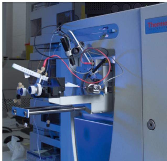
▲ Hochleistungs-Elektrosprayionisations-Massenspektrometer zur quantitativen Analyse von Molekülen. Geringste Mengen an Proteinen und Proteinfragmenten werden mittels Flüssigkeitschromatografie getrennt und direkt in das Massenspektrometer »versprüht«. Das Bild zeigt die Position des Sprüher – in diesem Fall einer Kapillarnadel aus Kieselglas – aus dem die Moleküle heraustreten.
